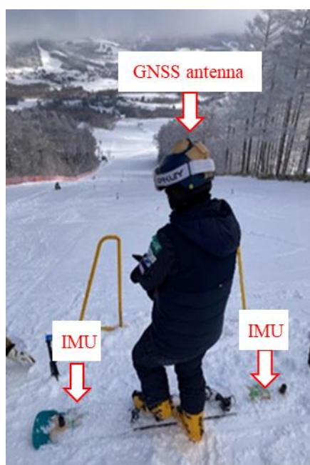
Fig. 2 計測の様子. ヘルメット上部GNSSアンテナボードのトップ部とテール部にIMUを装着
