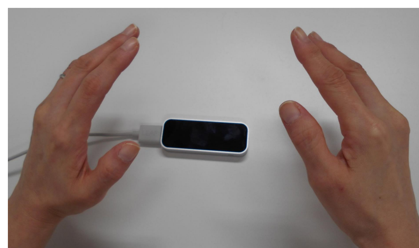
Leap motion; 赤外線カメラで手と指を認識する。
