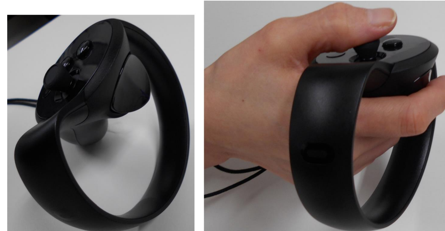
Oculus Touch; 手の位置と方向をモニタできる。全ての指の位置の認識はできないが、握っているか、開いているかを認識できる。
