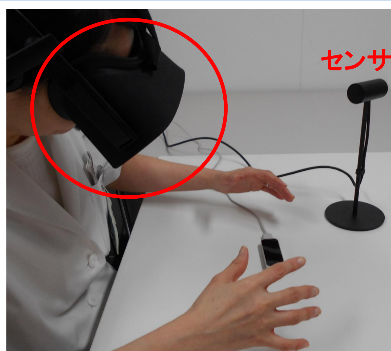
Oculus Rift; 操作者の顔の位置や方向をモニタできる。立体的なVR空間をみることができる。
