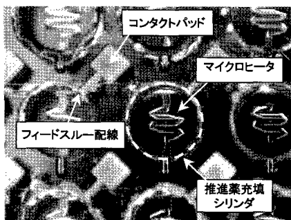
第3図 マイクロヒータ部の拡大写真
