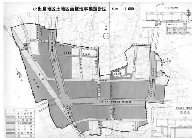
小出島地区土地区画整理事業 (S60-H4) 町施行、施行区域 6.3ha、総事業費73億円(町負担19億円)、 減歩率14.47%(河川改修先行買収により減価補償金充当前26.8%)
