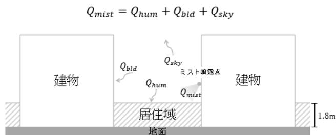
図-9 ドライ型ミストの気化熱が及ぼす効果
